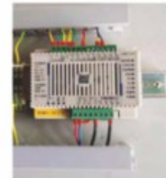
通风防尘控制 自清灰控制 界面除湿控制
