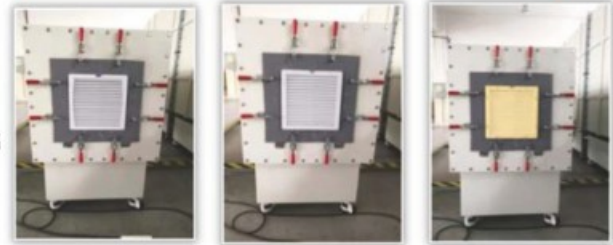
IP5X 过滤风扇 风洞测试
