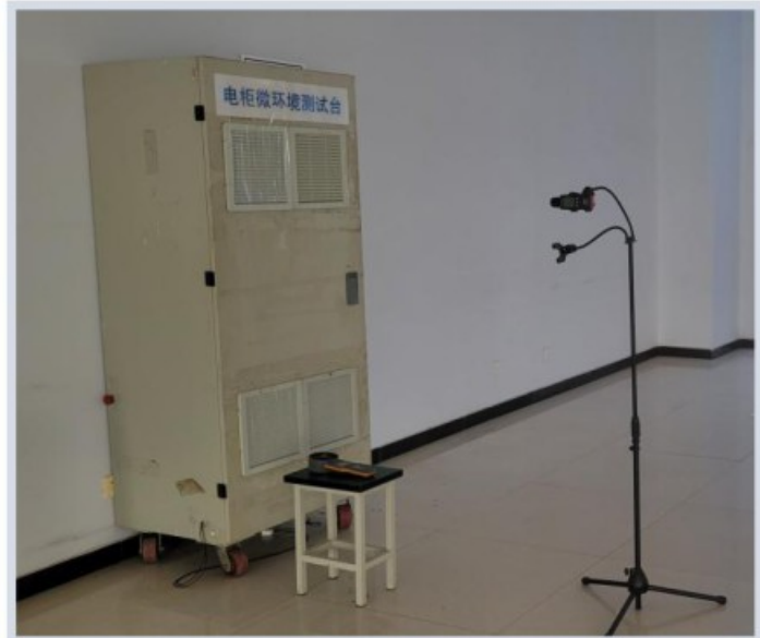
电柜微环境试台
