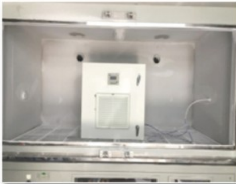
国家实验室IP6X尘密测试 强迫空气内外对流，无尘进入
