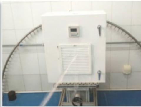
国家实验室IPX5喷水测试 各方向喷水测试，无水进入
